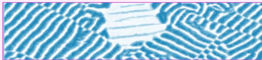
Immagine dei domini magnetici sulla superficie di un film di  $\text{Ni}_2\text{MnGa}$  (400 nm) - Magnetic Force Microscopy
