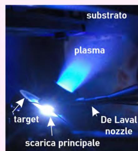
IJD (Ionized Jet Deposition): tecnica di crescita
