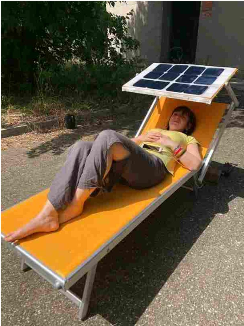
Arriva dal [Cnr](#) il carica smartphone solare e green a zero emissioni di CO2. L'Istituto dei materiali per l'elettronica ed il magnetismo del [Consiglio nazionale delle ricerche](#) di Parma ([Cnr-Imem](#)) ha infatti sviluppato un sistema di alimentazione fotovoltaico portatile per ricaricare dispositivi elettrici come smartphone e tablet. I ricercatori spiegano che "le celle solari di alimentazione sono applicabili anche su superfici curve".
