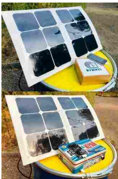
Il gruppo di ricerca 'NewPV' dell'Istituto dei materiali per l'elettronica ed il magnetismo del [Consiglio nazionale delle ricerche \(Cnr-Imem\)](#) di Parma, ha sviluppato dei sistemi di alimentazione portatili basati sul fotovoltaico (PV) per la ricarica di utenze elettriche a bassa potenza. Le celle solari di alimentazione sono flessibili, e quindi applicabili anche su superfici curve come ad esempio quelle degli ombrelloni e lettini da mare, come si vede dalle immagini allegate.
